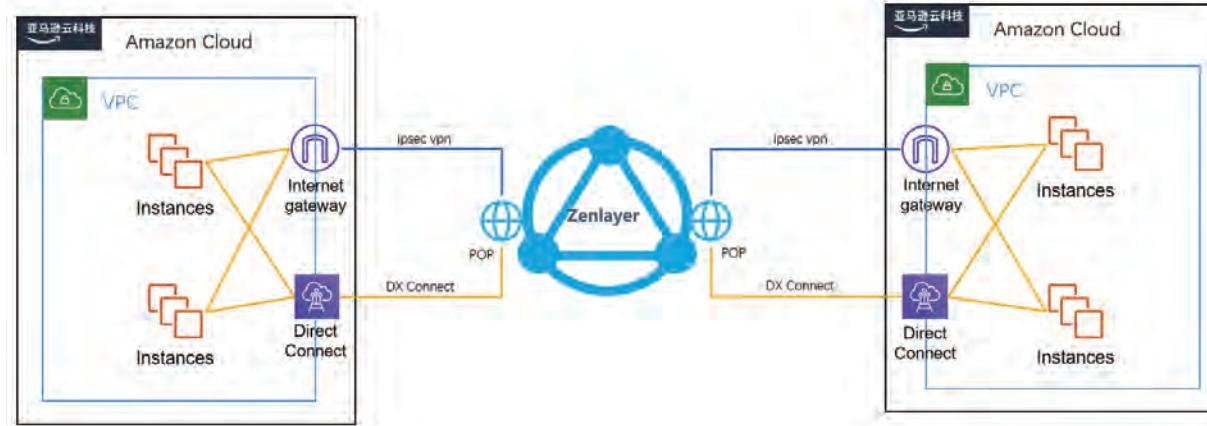
通过 DX Connect 打通 Zenlayer 骨干网到亚马逊云科技各个 Region 的连接通道, 与亚马逊云科技全球所有 Region 全部已打通。
